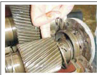
Figura 7 - Detalhe da gaiola do rolamento utilizado em um redutor com quebra da gaiola por falta de lubrificante.
