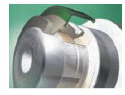
Figura 10 - Exemplo de eixo desgastado no contato com o lábio do retentor e esquema de montagem da bucha de desgaste.
