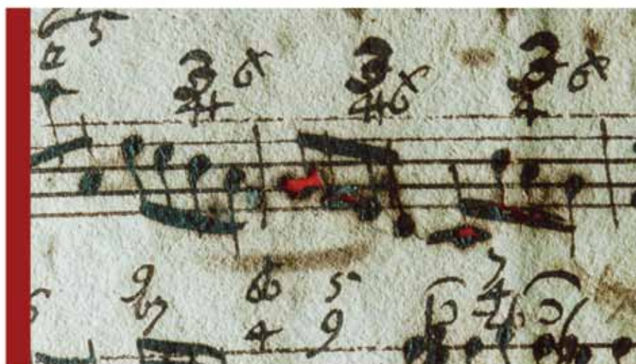
Figura 18. Tinta com excesso de íons ferro destrói o papel por corrosão / Figure 18. Ink with a surplus of iron ions destroys paper by corrosion
