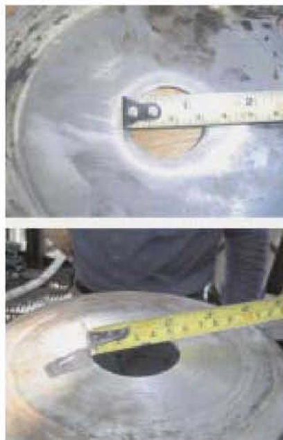
Figura 5. Dimensões do orifício da linha de recirculação de licor pesado do concentrador 1A para o concentrador 1D, ampliado em abril de 2005.
