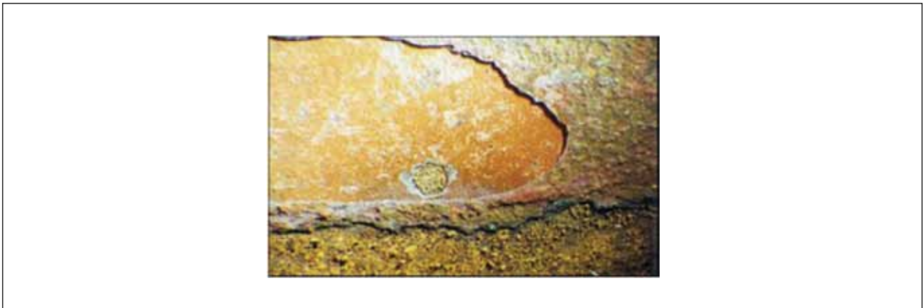
Figura 4. Imagem por microscópio óptico de superfície de tubo de superaquecedor de caldeira de recuperação que teve corrosão acelerada por mecanismo de “oxidação ativa” (Mäkipää et al. , 2004) / Figure 4. Optical microscope image of recovery boiler superheater tube surface which has experienced accelerated corrosion by the mechanism of “active oxidation” (Mäkipää et al. , 2004)
