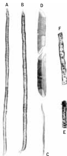
Figura 4. Traqueídeo de conífera abeto (a – ampliação x55), traqueídeo de conífera pinus (b – x55), fibra libriforme de folhosa bétula (c – x55), elemento vaso de folhosa bétula (d - x55), raio parenquimatoso de conífera abeto (e - x242) e raio traqueídeo de conífera abeto (f - x242).
