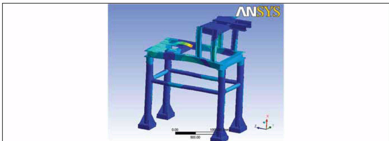
Figura 11. Modo Shape associado a frequência de 258 Hz / Figure 11. Shape mode associated to the 258 Hz frequency
