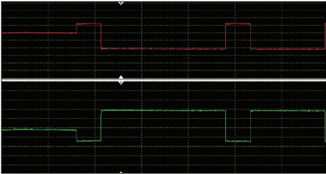
**Figura 4.** Exemplo de medição do sinal de rede PROFIBUS após correção da instalação
