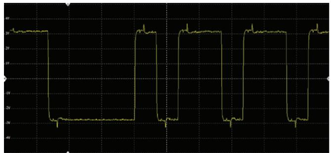
**Figura 9.** Exemplo do sinal de comunicação PROFIBUS em CCM de gaveta com o uso do repetidor PROFIHUB
