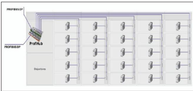
**Figura 8.** Exemplo de uso de repetidor PROFIBUS para segmentar e isolar as colunas do CCM
