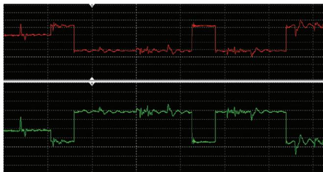
**Figura 2.** Exemplo de medição do sinal de rede PROFIBUS, com ruídos provenientes de EMC
