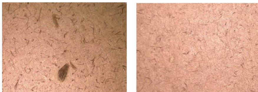
Figura 2. Folha de celulose com 100 g/m 2 e kappa 55 antes (esquerda) e após (direita) depuração
