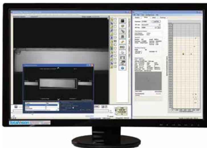
TotalVision™ oferece uma plataforma simples e unificada de monitorização e de inspeção da folha, utilizando câmaras digitais de alta velocidade sincronizadas com iluminação LED. Identifique e elimine todas as quebras e todos os defeitos ao longo do processo de produção de papel e tissue com um sistema TotalVision™ de Papertech. Contacte-nos para mais detalhes.
