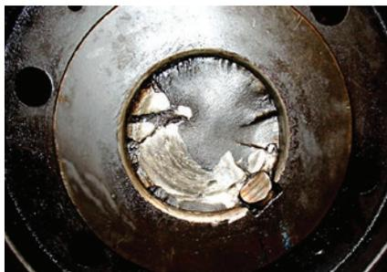
Figura 13. Detalhe da Superfície de Fratura
