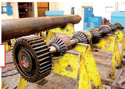
Figura 12. Aspecto Geral do Eixo Falhado
