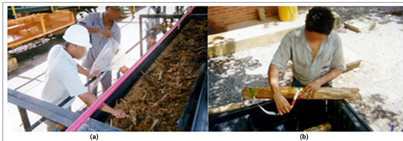
Figura 5 – Separação (a) e medição do diâmetro (b) dos toretes gerados durante o teste
