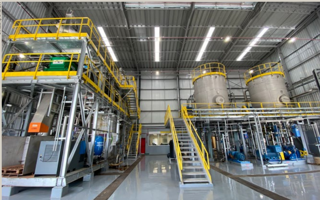
O Parque de Plantas Piloto simula uma unidade fabril para realização de estudos e testes industriais em frentes de pesquisa relacionadas à lignina e à celulose microfibrilada
