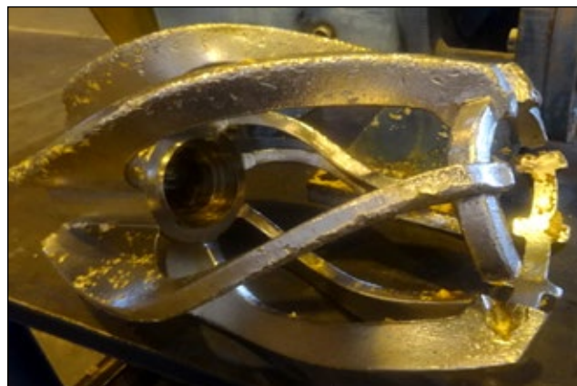
Figura 1 – Rotor Fluidificante Desgastado Fonte: Autores
