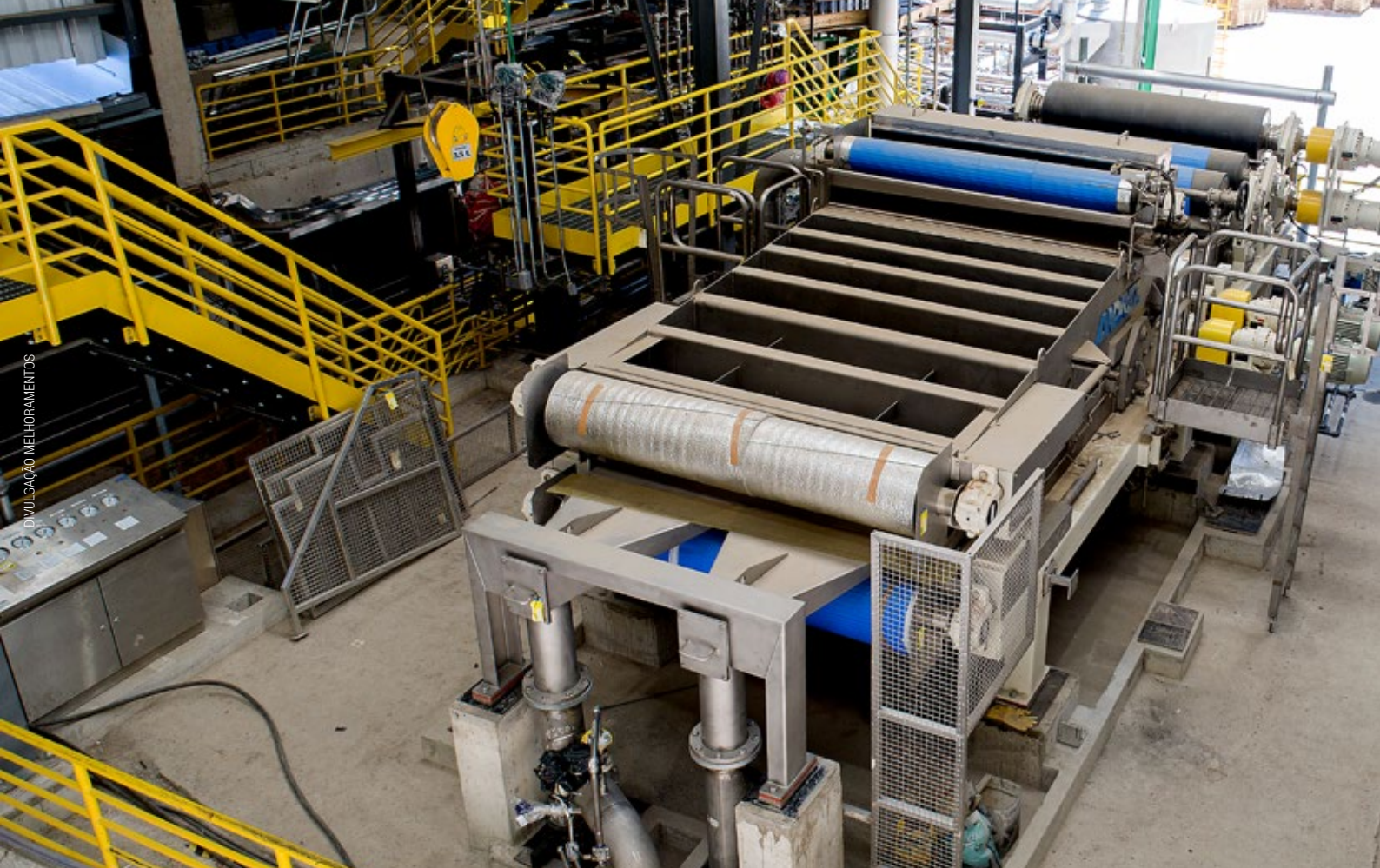
A nova linha de produção divide-se em quatro blocos principais, entre eles, engrossamento ( Twin Wire Press )
