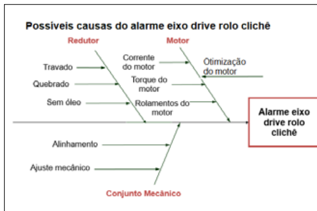
Figura 7 – Diagrama Causa efeito aplicado ao alarme eixo drive rolo clichê Fonte: Os Autores (2017)
