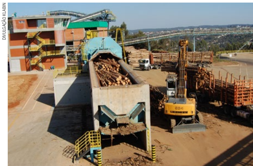
Descascador no site da Klabin: parte do processo de preparo da madeira, que gera cascas utilizadas como biomassa
