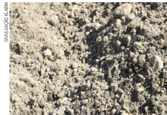
Dregs despontam como um dos principais tipos de resíduos minerais provenientes da fabricação de celulose e papel
