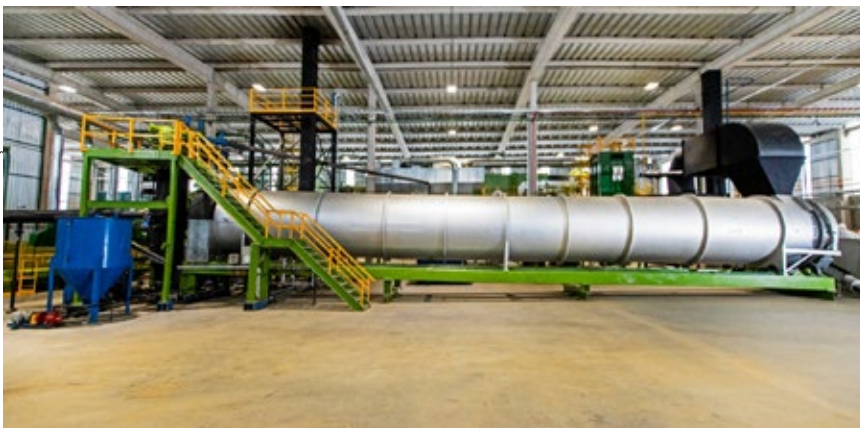
UPAC: tecnologia que utiliza resíduos que não podem ser reciclados de outras formas, mas que servem como matéria-prima para produção de insumos energéticos alternativos aos fósseis
