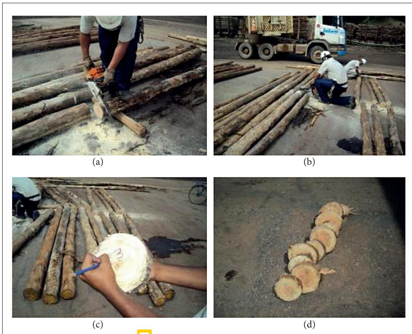
Figura 4. Separação e identificação das amostras
