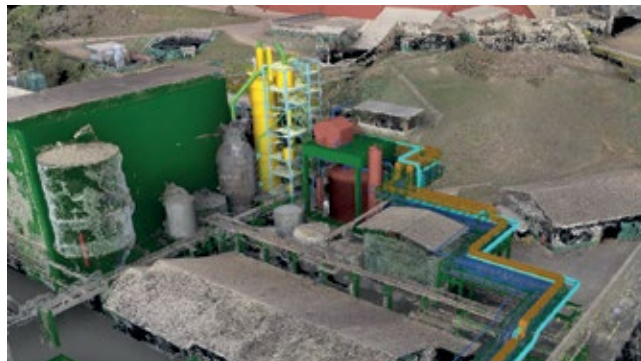
BOP – Integração da nuvem de pontos com o modelo 3D PDMS
