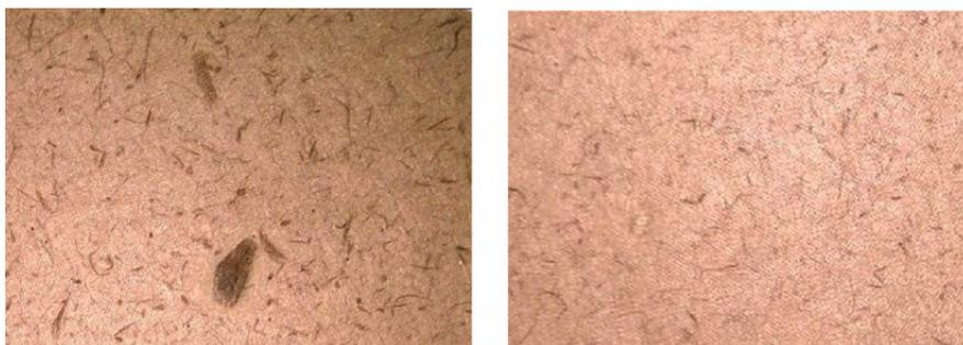
Figura 2. Folha de celulose com 100 g/m<sup>2</sup> e kappa 55 antes (esquerda) e após (direita) depuração
