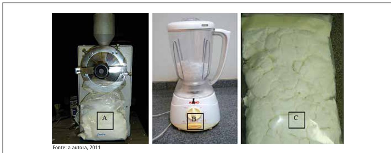
Figura 1. Equipamentos laboratoriais para preparo de amostras e uma amostra industrial, sendo: (A) moinho de faca, (B) liquidificador comercial adaptado, sem cortes, como alternativa de preparo de amostra e (C) amostra de polpa de Eucalyptus com preparo industrial utilizada nos experimentos com fibra curta
