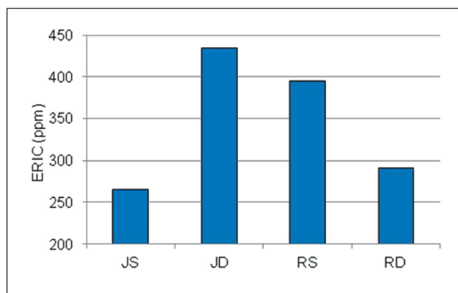
Figura 3. Resultados do ensaio óptico ERIC para papéis formados após flotação
