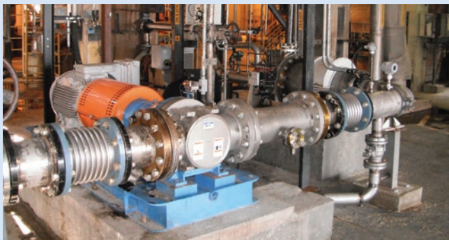
Tri-O™ Mixer Misturador de Químicos O_2 & ClO_2 Alta Eficiência: Hi-shear Baixo Consumo de Energia
