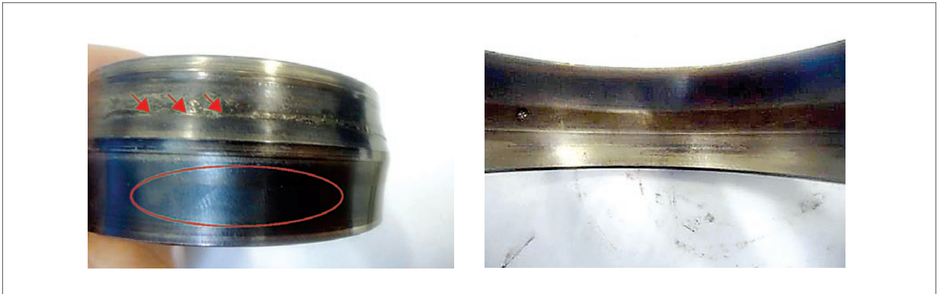
Figura 7. Aspecto da pista dos anéis interno e externo – Rolamento LOA
