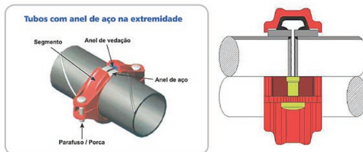
Figura 6. Tubo com anel de aço soldado a extremidade
