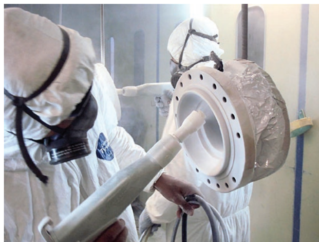
Figura 2. Aplicação do revestimento pelo processo eletrostático
