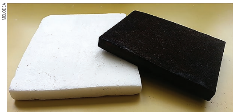
Placas de espuma rígida resistentes à água e ao fogo contendo nanocristais de celulose
