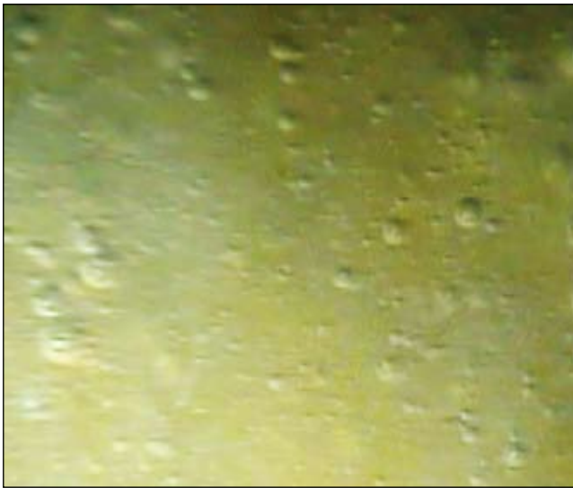
Figura 7. Bolhas no dispositivo de teste, velocidade do rotor 1.000 rpm / Figure 7. Bubbles in the test device, rotor speed 1000 rpm
