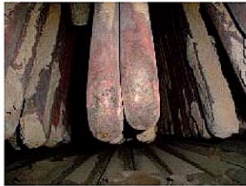
Figuras 4, 5, 6 e 7. Deformações e desalinhamentos de componentes de caldeiras (fotos com propósito ilustrativo somente) / Figures 4, 5, 6, and 7. Boiler components deformations and misalignments (photos with illustrative purpose only)
