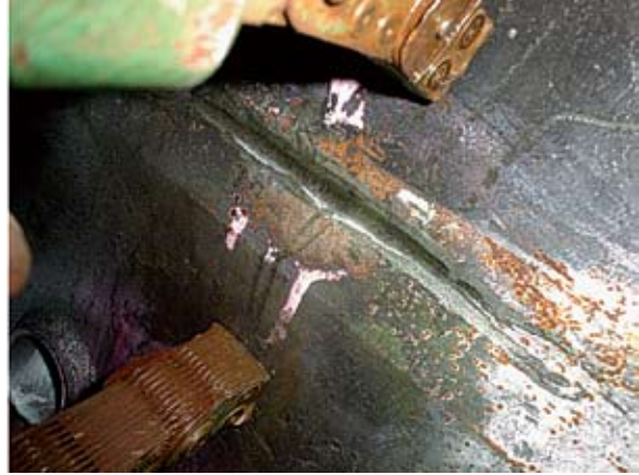
Figuras 10 e 11. Soldas do balão. Observar linha de óxido adjacente à solda, representando possível indicação de trinca comprovada neste caso real. O exame por partículas magnéticas é, portanto, recomendável após um ESP / Figures 10 and 11. Drum welds. Observe the oxide line adjacent to the weld, representing a possible crack indication, proven in this real case. Therefore, magnetic particles testing is recommendable after an ESP
