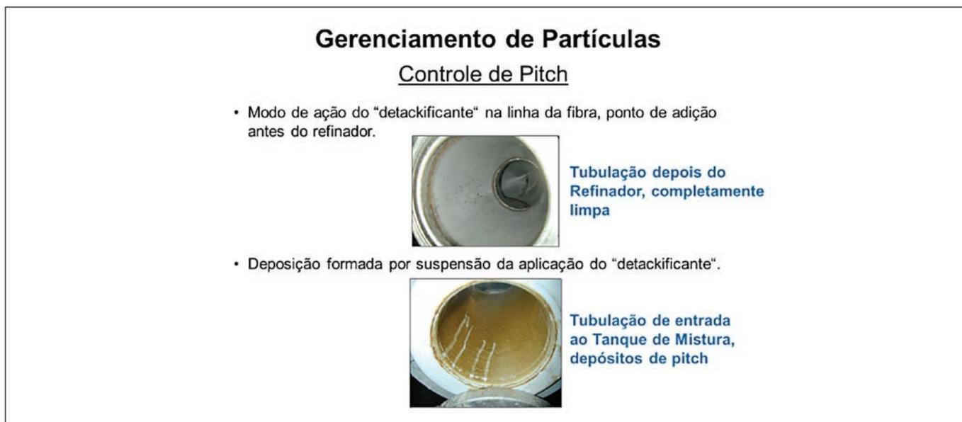
Figura 3. Efeito da "Detackificação" na Deposição de Pitch
