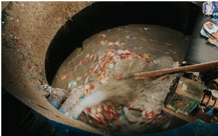
Processo de reciclagem da Revita: empilhadeiras transportam os fardos de embalagens Longa Vida pré e pós-uso para os hidrapulpers, onde o material é misturado à água e agitado por aproximadamente meia hora
