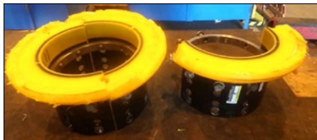
Figura 3 – Quebra do Acoplamento Fonte: Autores
