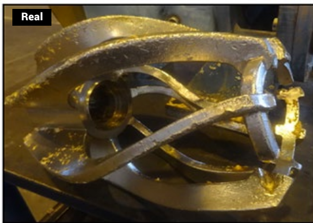
Figura 8 – RF Original de Aço Inoxidável Quebrado Fonte: Elaborado pelos autores
