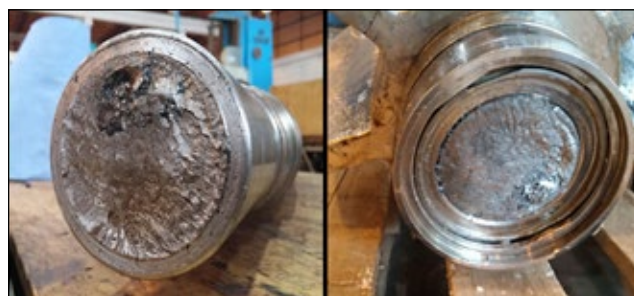
Figura 2 – Eixo do MQ Quebrado Fonte: Autores
