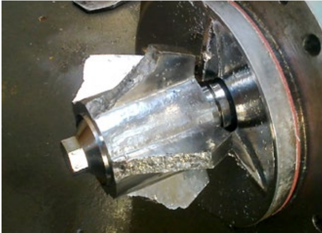
Figura 8 – RF Original de Aço Inoxidável Quebrado Fonte: Elaborado pelos autores
