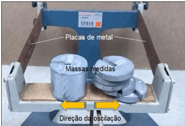
**Figura 2.** Balança inercial
