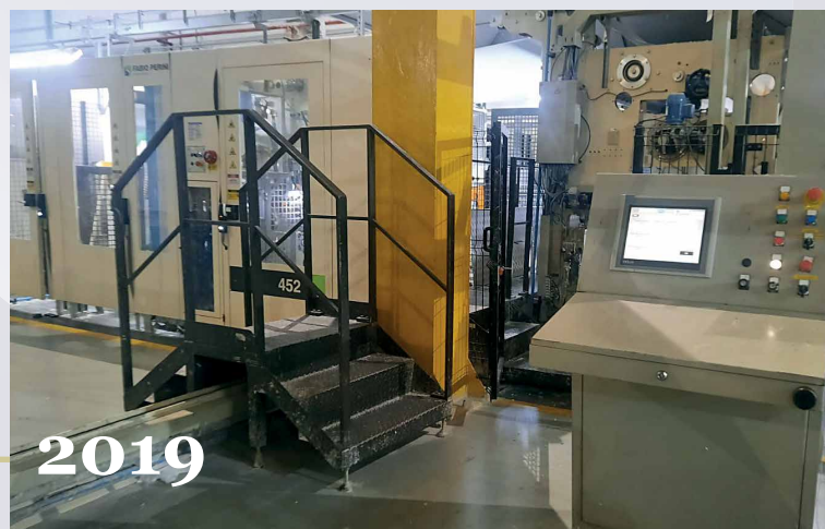
Atualização da linha Perini para laminação com água, a partir da instalação do kit Aquabond TM-452/D.
