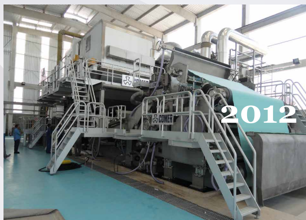
Startup da Máquina de Papel 3, uma Crescent Former da Comer, e investimentos expressivos em linhas de conversão para guardanapos e lenços.
