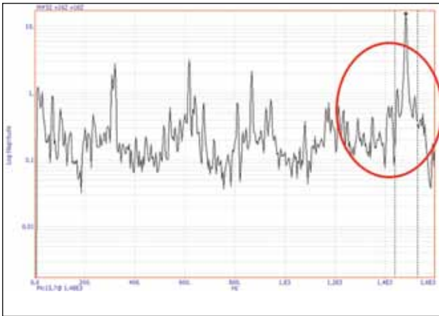
Espectro 4. Primeira prensa: frequência 1480 Hz com bandas laterais GMF1 Spectrum 4. First press: 1480 Hz frequency with side bands GMF1
