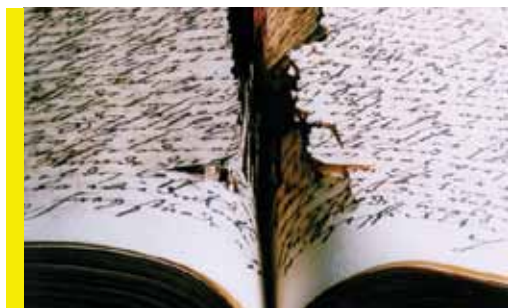
Figura 17. Envelhecimento do papel devido à colagem ácida e um aparelho de desacidificação Figure 17. Aging of paper because of acid sizing and a de-acidification apparatus
