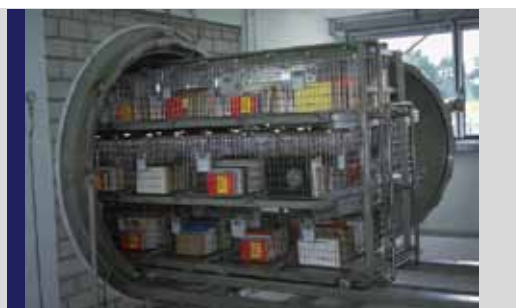
Figura 17. Envelhecimento do papel devido à colagem ácida e um aparelho de desacidificação Figure 17. Aging of paper because of acid sizing and a de-acidification apparatus
