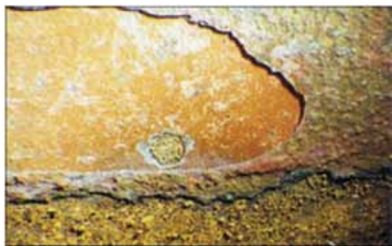
Figura 4. Imagem por microscópio óptico de superfície de tubo de superaquecedor de caldeira de recuperação que teve corrosão acelerada por mecanismo de “oxidação ativa” (Mäkipää et al. , 2004) / Figure 4. Optical microscope image of recovery boiler superheater tube surface which has experienced accelerated corrosion by the mechanism of “active oxidation” (Mäkipää et al. , 2004)
