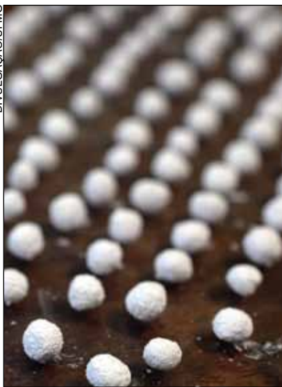
Pequenas esferas cerâmicas, capazes de absorver até 40% do CO 2 expelido
