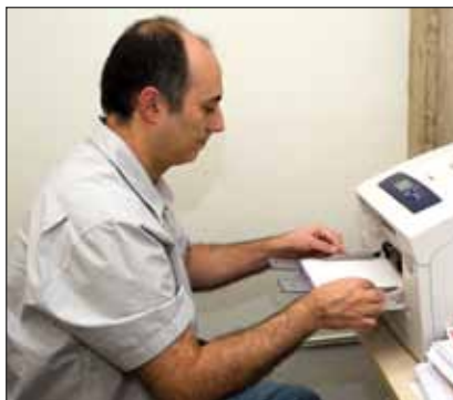
Impressora de tinta sólida é usada para transferir a cera ao papel de cromatografia
