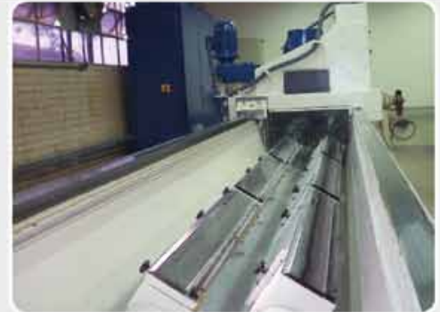
Afiadoras/retíficas de facas com uma ou duas linhas de mesa. Dispositivos especiais para fixação de rasps.
