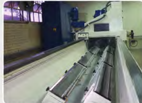
Afiadoras/retificas de facas com uma ou duas linhas de mesa. Dispositivos especiais para fixação de raspas.
