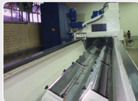
Afiadoras/retíficas de facas com uma ou duas linhas de mesa. Dispositivos especiais para fixação de raspas.
