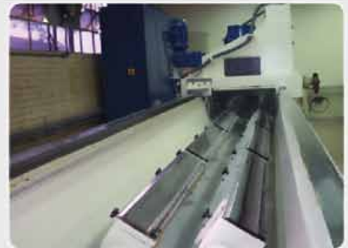
Afiadoras/retíficas de facas com uma ou duas linhas de mesa. Dispositivos especiais para fixação de raspas.
