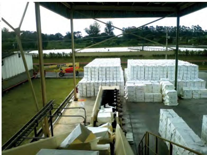
A alimentação da celulose do pátio da Santher é feita automaticamente por esteiras até o Hidrapulper
