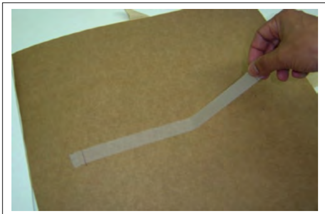
Figura 7. Retirada da fita adesiva em ângulo de 45°
