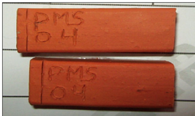
Figura 1. Amostra dos corpos de prova queimados a 950°C
