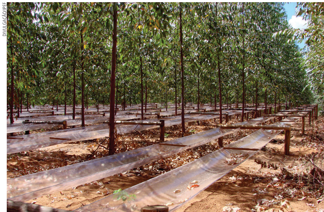
Sistema de exclusão de chuva do TECHS, que induz ao estresse hídrico para estudar o quanto as plantas aguentam em período de seca
