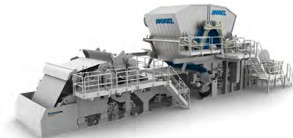
A partir do sucesso da máquina tissue TM1 fornecida pela Andritz à Hebei Yihoucheng, na China, a empresa recebeu mais um pedido, desta vez para uma máquina PrimelineCOMPACT II com yankee de aço. A máquina tem velocidade de projeto de 1.600 m/min e largura de 2,85 m. O diâmetro do yankee de aço é de 3,66 m. O start-up está previsto para o final de 2015.
