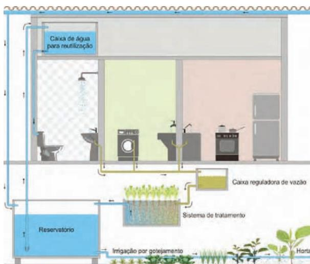
Desenho esquemático do sistema de reaproveitamento de água
