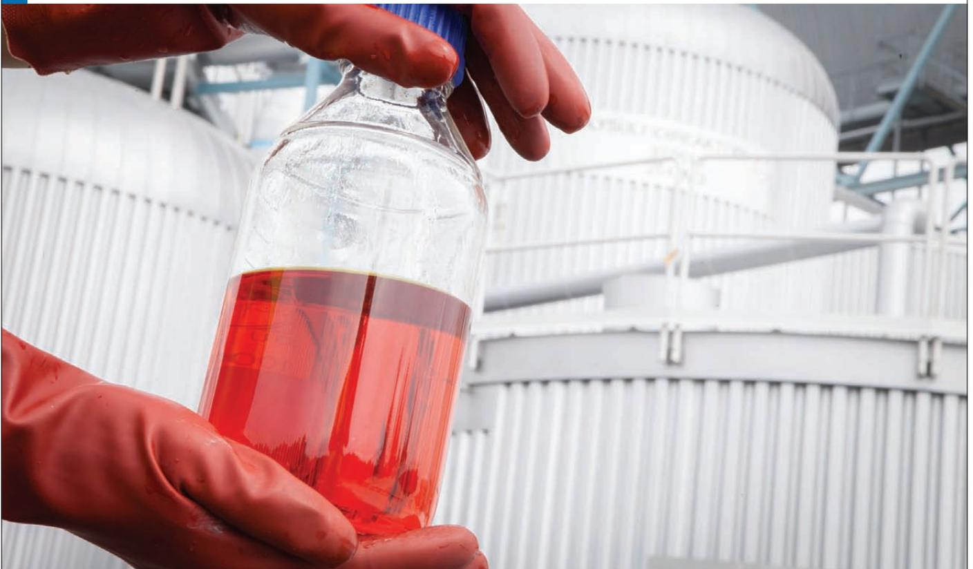
**Com o sucesso da instalação da planta de cozimento polissulfeto em uma das mais importantes fábricas de celulose do mundo, a ANDRITZ adiciona uma nova cor ao seu processo.** O licor do cozimento polissulfeto tem uma cor laranja característica. O processo aumenta o rendimento para o produtor de celulose – e aumenta as
