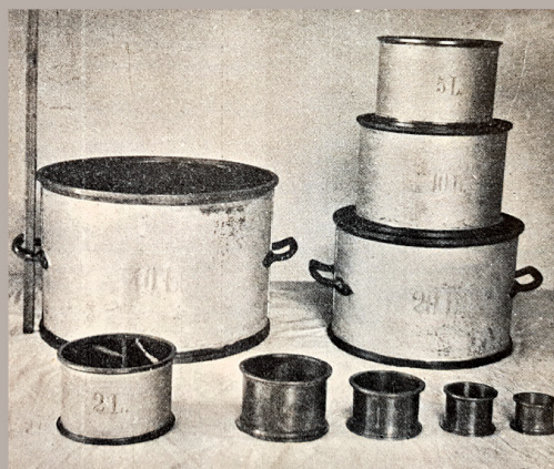
Conjunto padrão de medidas de volume da época do Império, de (40 a 0,05) litros (3, p13)
