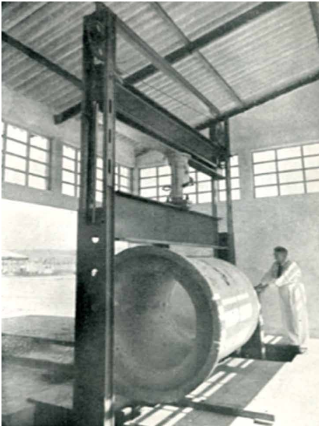
Figura 2. Máquina para ensaiar a compressão diametral de tubos de grandes dimensões, década de 1940 (projeto e construção do IPT)
